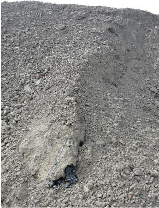
Bild 1: Bodenhaufwerk mit Teerölkonglomeraten
