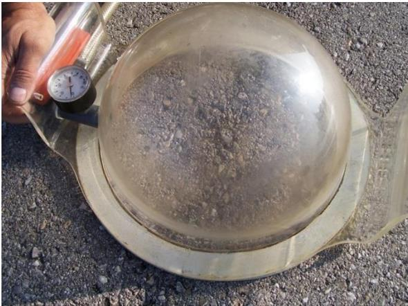
Abb. 1: Dichtigkeitsprüfung mit einer Vakuumglocke
