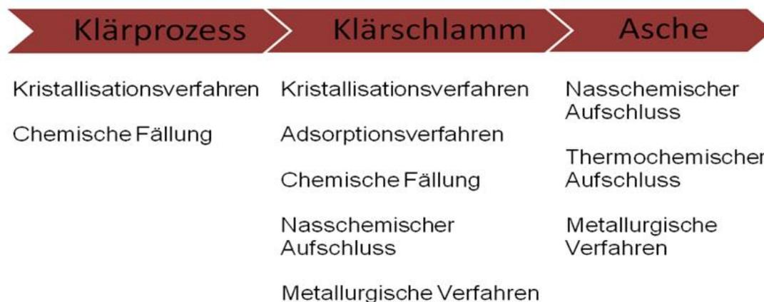
Abbildung B: Genereller Überblick zu Möglichkeiten zur Phosphor-Rückgewinnung
