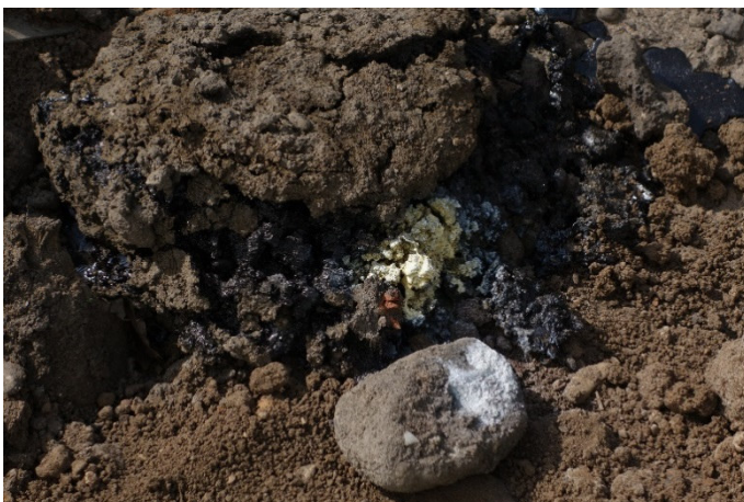
Bild 3: Positiver (gelb) und negativer (weiß) Lacktest
