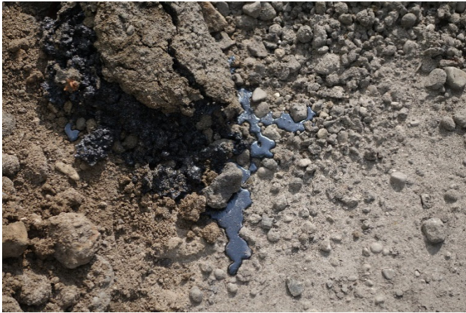
Bild 2: Von Boden umhülltes Teerölkonglomerat mit austretender Flüssigphase
