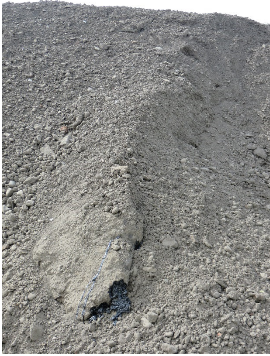
Bild 1: Bodenhaufwerk mit Teerölkonglomeraten
