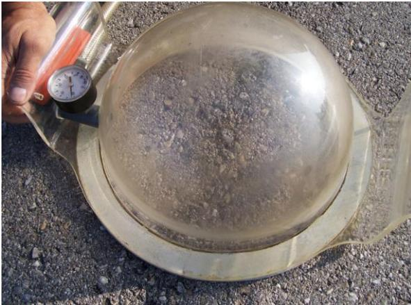
Abb. 1: Dichtigkeitsprüfung mit einer Vakuumglocke
