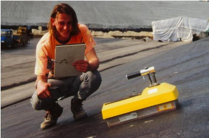
Abb. 3: Zerstörungsfreie Dichtebestimmung mit der Isotopsonde
